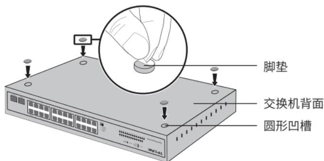
图2-1 桌面安装示意图
