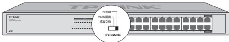
图1-10 系统模式选择开关示意图
